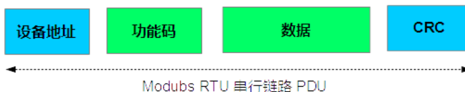
图 3 Modbus RTU 串行链路 PDU
